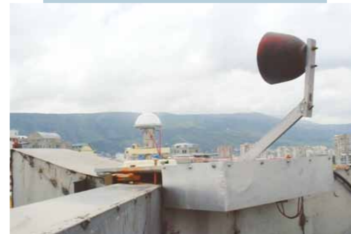
მზის ჯამეხი ხაღაცის გაზომის (პირანომეტრი) Equipment for measuring broadband solar radiation (Pyranometer)
